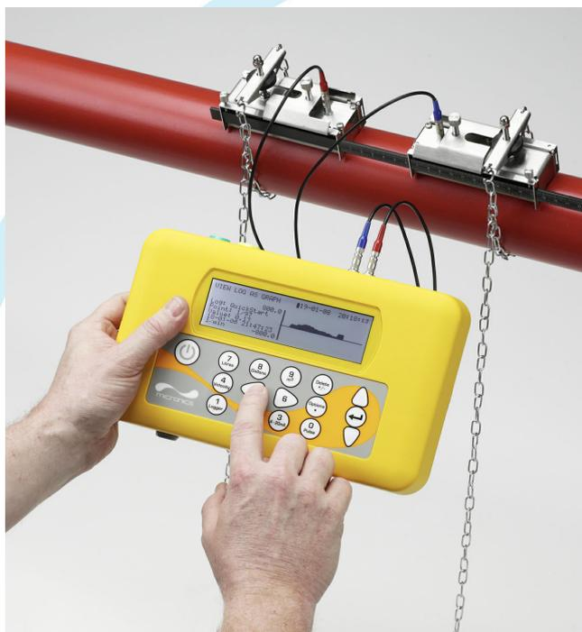
Innovativo e versatile, il PF330 è un misuratore di portata ad ultrasuoni "transit time", progettato per quantificare in modo non invasivo la portata su tubazioni chiuse, ovvero senza l'introduzione di parti meccaniche all'interno della condotta.
